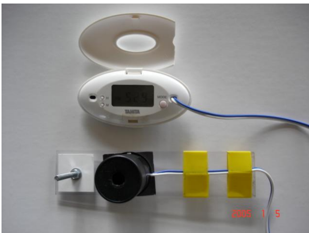
写真3 UV-B測定器 (UV-mira) と科学部員製作の直射光の導入器
