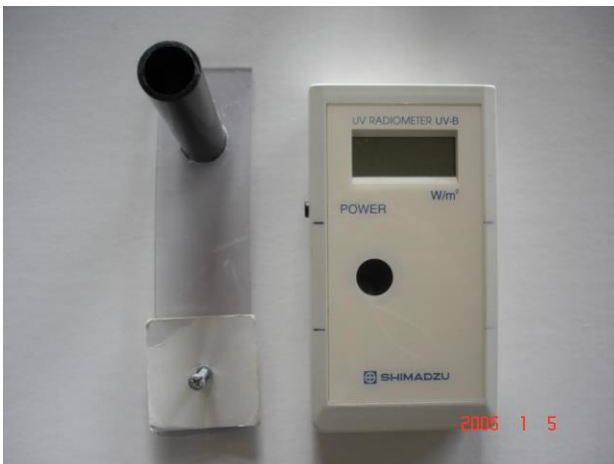
写真2 UV-B測定器 (SHIMAZU) と科学部員製作の直射光の導入アダプター
